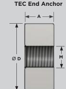
**Description** Ab d Mb mm mm  $\mathbf{m}\mathbf{m}$ TSE 12 - M16 12 16 min 23 TSE 16 - M20 min 30 16 20 TSE 20 - M24 20 24 min 38 TSE 25 - M30 25 30 min 44 TSE 32 - M42 32 42 min 54
